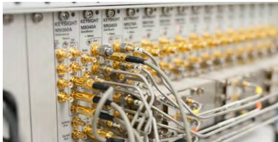
Рис. 3. M9485A - новый многопортовый векторный анализатор цепей
