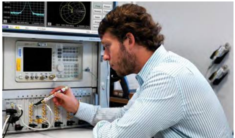
Рис. 1. Добавление к существующей испытательной установке двух 2-портовых векторных анализаторов цепей в формате PXI позволяет создать мощное средство для тестирования параметров устройств, не увеличивая при этом высоту системы тестирования или занимаемую ею площадь
