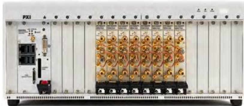
Рис. 2. В данной универсальной многопортовой конфигурации в одном шасси используются восемь 2-портовых векторных анализаторов цепей в формате PXI
